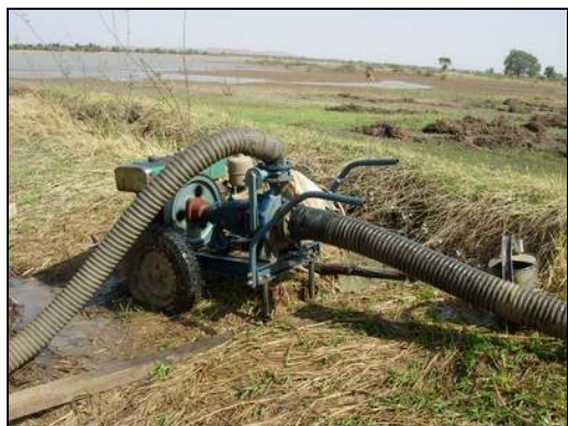
Figure 7. Groupe Motopompe Amec (Luc, J.Ph. 2006).
